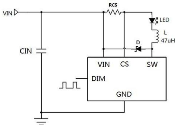
输出电流与 PWM 信号占空比成正比，输出平均电流可以由以下两式表示：
